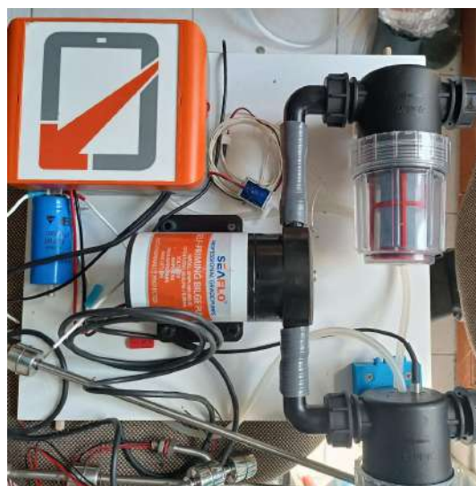
Figure 13 : système de renouvellement de l'eau des bacs
