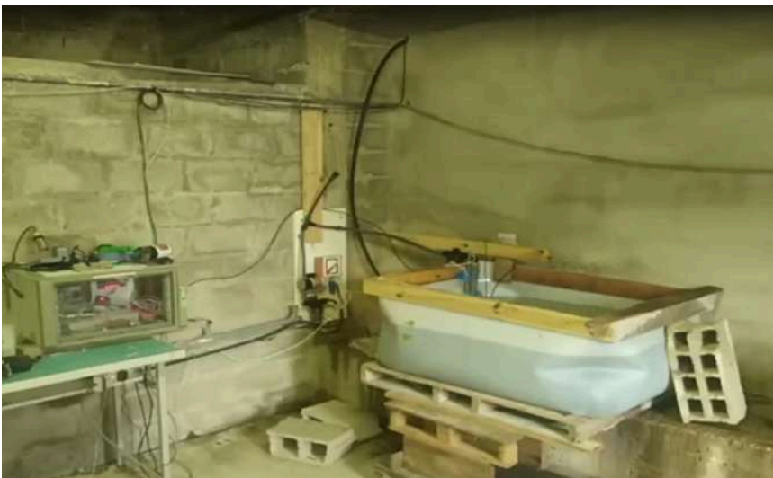
Figure 12 : Bac de maturation des graines du local n° 2 (Beurivage) : IBC de 1 m 3 coupé en 2. Volume utile 300 L env.
